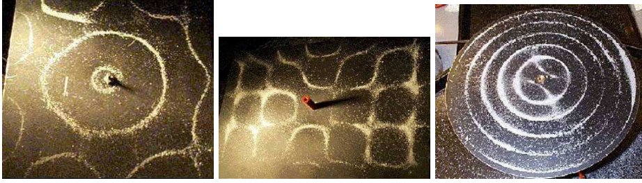
Figure 2: Különböző Chladni-féle porábrák.
